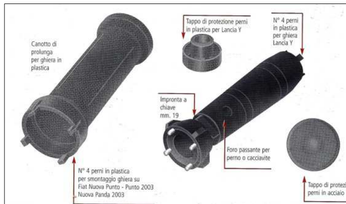
Cod. 9050074 Attrezzo per lo smontaggio ed il rimontaggio degli specchietti retrovisori esterni vetture Fiat- Alfa – Lancia (Nuova Punto,Punto 2003,Nuova Panda 2003, Idea, Brava/o,Marea,Palio,Doblo',Tipo,Tempra,Croma,y, Nuova Delta,Dedra,Thema ,155
