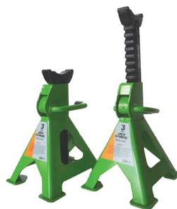
Coppia cavaletti sostegno COD.9080137 Portata 3 Ton. Altezza da 292-425mm COD.9080141 Portata 6 Ton. Altezza da 400-605 mm
