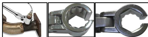
CHIAVE A BUSSOLA PER SONDE LAMBDA SNODATA APERTA CON DOPPIA IMPRONTA, A IMPUGNATURA PIEGATA.
