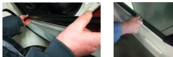
Cod.9050154 ATTREZZO PER SMONTAGGIO RASAVETRO FIAT PANDA E 500X Questo pratico attrezzo permette lo smontaggio senza complicazioni e rotture del rasavetro, permette lo smontaggio dall'esterno dell' auto senza smontare il pannello porta e il meccanismo alzavetro
