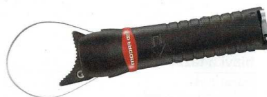
CHIAVE FILTRI OLIO A FASCIA CON EFFETTO A CRICCHETTO E SERRAGGIO AUTOMATICO Da 66 a 105 mm. COD. 9030038
