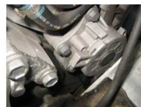
KIT PER IL TENSIONAMENTO DEL TENDICINGHIA DEGLI ORGANI AUSILIARI DEI MOTORI DIESEL MONTATI SULLE VETTURE FORD-MAZDA PEUGEUT-CITROEN-VOLVO-MINI- TOYOTA COD. 9070477
